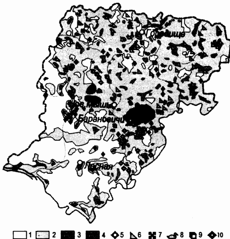
Рис. 2. Степень химического загрязнения подземных вод Барановичского района: 1 — низкая (практически незагрязненные); 2 — средняя (степень загрязнения ниже ПДК, но выше фона); 3 — периодически высокая; 4 — высокая (степень загрязнения выше ПДК). Источники загрязнения подземных вод: 5 — поля орошения поверхностными водами; 6 — животноводческие фермы; 7 — свиноводческие комплексы; 8 — птицефабрики; 9 — фермерские хозяйства; 10 — садоводческие товарищества
